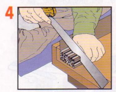
単位文様材を集成して一定の寸法に切断する。
